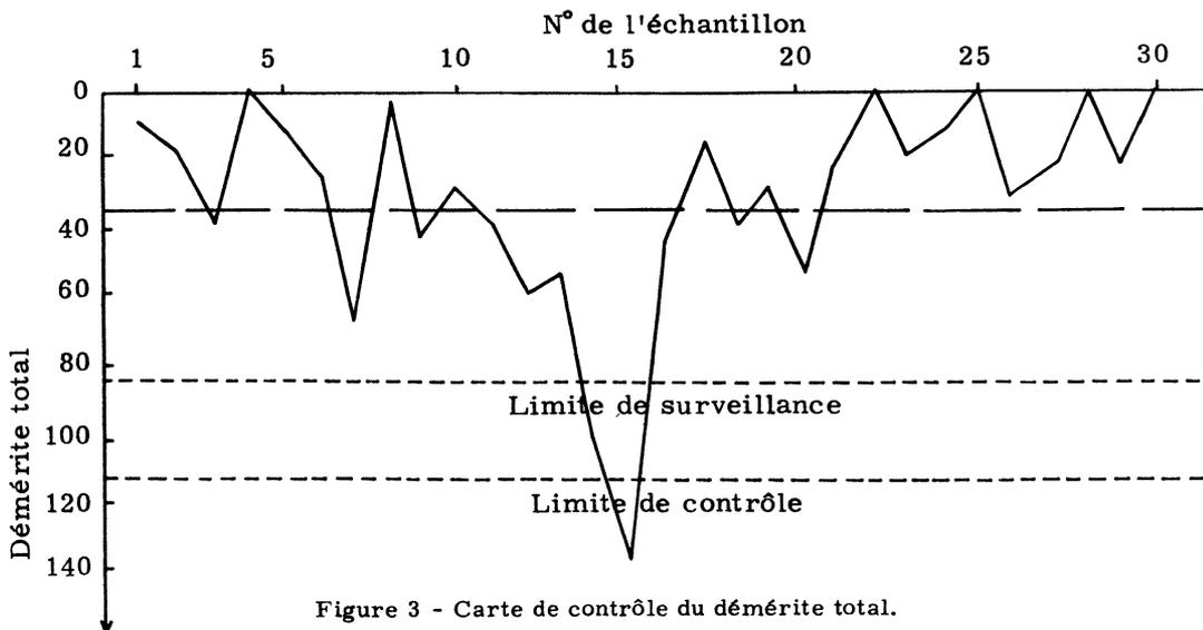
Figure 3 - Carte de contrôle du démerite total.
