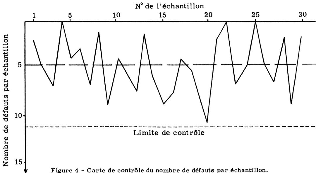
Figure 4 - Carte de contrôle du nombre de défauts par échantillon.
