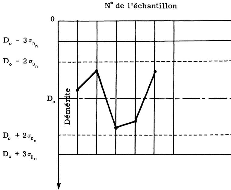
Figure 1 - Schéma de la carte de contrôle du démérite total.
