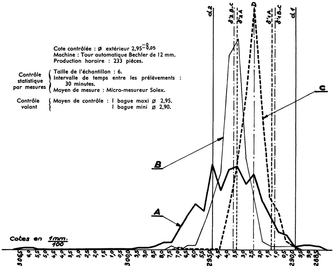
Intervalle de classe  $5 \mu$ . Par exemple, on a groupé sur l'axe de la classe 2,950 les mesures comprises entre 2,9475 et 2,9525.
