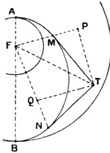
côtés de cet angle sont égales. Remarquons tout de suite que les segments de l'espace  $T'P'$ ,  $T'Q'$ , parallèles au plan de projection et qui se projettent en  $TP$ ,  $TQ$ , sont parallèles aux tangentes en  $M'$ ,  $N'$  aux cercles qui sont des parallèles du tore.
