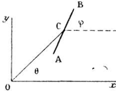
*élastique OC dont on néglige la masse et dont la longueur à l'état naturel est  $a$ . Le point C étant écarté de O de façon à tendre le fil et à lui donner une longueur  $r_0$  supérieure à  $a$ , on lance la barre sur le plan.*
