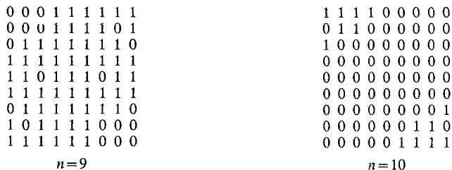
n=9 n=10 Fig 3 - Zones de contact avec l'obstacle dans les itérations paires et impaires de l'algorithme I
