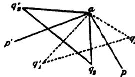
points  $q_1$  et  $q_2$  se projettent en deux points symétriques par rapport à  $ap$ , et les points  $q'_1$  et  $q'_2$ , en deux points symétriques par rapport à  $ap'$ . Les droites  $q_1q'_1$  et  $q_2q'_2$  sont égales dans l'espace et font le même angle avec le plan de projection. Elles sont donc égales aussi en projection.
