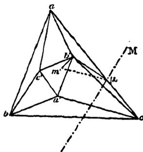
Les diverses droites tracées sur la figure sont de longueurs invariables, et l'on a en  $abca'b'c'$  un octaèdre qui se déforme sans altération de ses arêtes. (Nous avons déterminé, dans un précédent
