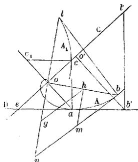
la spirale  $A$  touche la droite  $D$  : on sait que pour construire le centre de courbure correspondant au point  $a$ , il faut élever, sur le rayon vecteur  $oa$ , la perpendiculaire  $oc$  jusqu'à sa rencontre en  $c$  avec la normale qui passe en  $a$ . Le point  $c$  ainsi obtenu est le centre de courbure cherché.
