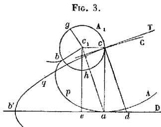
de  $C$ , nous allons construire la tangente  $T$  qui passe par le point  $c$ , centre de courbure de la développante  $A$ , correspondant au point  $a$ . Soit  $c_1$  le centre de la circonférence  $A_1$ , développée de  $A$ , d'après ce que nous savons (n° 2), il faut abaisser du point  $c$  une perpendiculaire sur  $ac_1$ , et l'on a la tangente cherchée.
