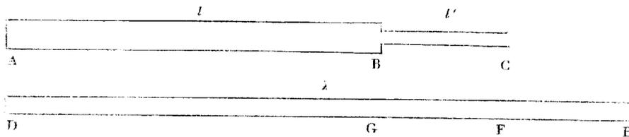
Soit de même ABC un tuyau fermé en A, ouvert en C, ayant pour section  $\omega$  dans une étendue AB =  $l$ , et pour section  $\omega'$  dans l'étendue BC =  $l'$ . Les conditions qu'il s'impose en B font encore que la densité soit la même dans les deux parties du tuyau, et que les vitesses y soient en raison inverse des sections.
