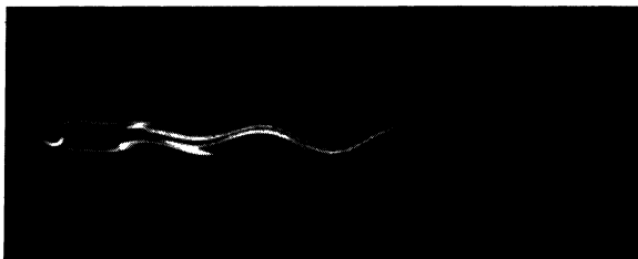
PLANCHE III, fig. b. — Aspects normaux du sillage en régime permanent.
