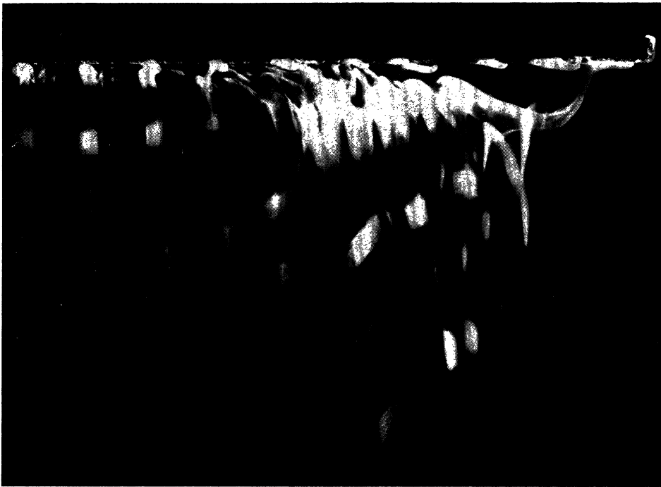
PLANCHE III, fig. a. — Aspect du sillage et du mouvement de circulation pour un cylindre de 6 mm. de diamètre.
