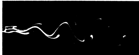
PLANCHE III, fig. b. — Aspects normaux du sillage en régime permanent.
