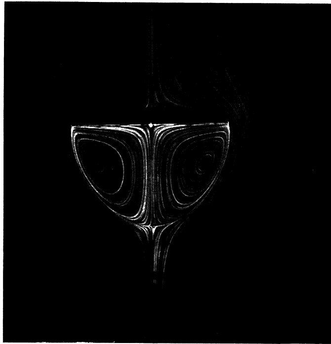
PLANCHE I, fig. a. — Aspect du sillage d'une plaque plane immergée dans l'huile pour un faible nombre de Reynolds.
