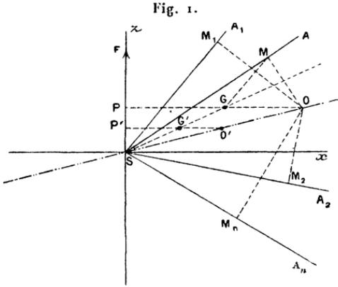
On sait, en effet, que le centre instantané se trouve sur la perpendiculaire OP abaissée du centre de gravité G de l'ensemble des points M, sur la direction de la force F et à une distance OG de ce point telle qu'on ait la relation
