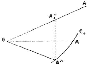
Soit  $A'$  la position de ce point quand la figure a tourné de l'angle  $\alpha$ , et soit  $A''$  le point de la courbe  $C_0$  qui vient en  $A$  après cette rotation.
