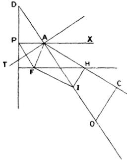
Soit  $I$  le milieu de  $OA$ ; le point  $D$ , symétrique de  $I$  par rapport à  $A$ , se trouve sur la directrice  $DP$  perpendiculaire sur  $AX$ , et le foyer  $F$  est symétrique de  $P$  par rapport à la tangente  $AT$  perpendiculaire sur  $OA$ .
