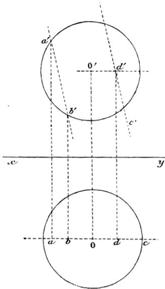
Le centre de la sphère est projeté en  $O, O'$ ; les points  $o$  et  $o'$  sont à  $0^m,102$  de la ligne de terre et la droite  $OO'$  est au milieu de la feuille; le rayon de la sphère à  $0^m,092$  de longueur.
