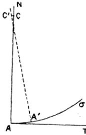
la surface au point  $A'$ , voisin de  $A$ , se projette sur le plan NAT, suivant la normale à la courbe  $A\sigma$ ; si je coupe alors la normale par le plan horizontal du point  $C$ , centre de courbure de la courbe  $A\sigma$ , la courbe d'intersection a pour tangente la limite de  $CC'$  qui est une perpendiculaire au plan NAT. Le plan tangent à la normale au centre de courbure  $C$  de la section NAT est donc perpendiculaire au plan NAT.
