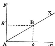
minuent en même temps que  $AB$ . De même, en projetant le point  $B$  en  $b'$  sur la perpendiculaire à  $Ax$  au point  $A$ , on voit que le rapport  $\frac{Ab'}{AB}$  augmente à mesure que  $AB$  diminue. Donc, si l'on fait tendre  $AB$  vers zéro, le rapport  $\frac{Bb}{BA}$ , qui va en décroissant et qui reste supérieur au rapport *croissant*  $\frac{Ab'}{AB}$ , tend vers une limite *différente de zéro*.
